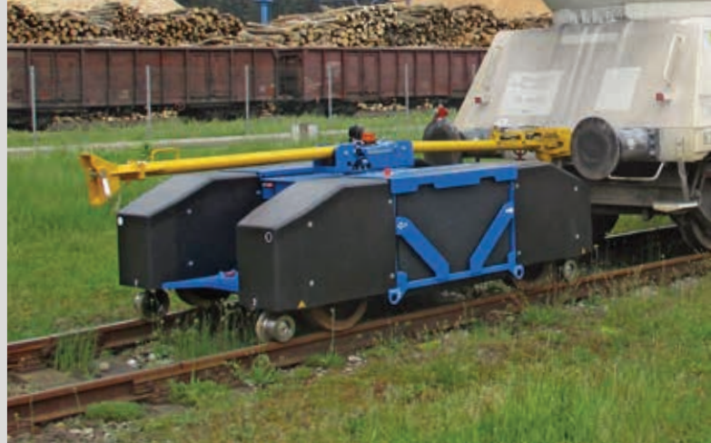
ZAGRO E-MAXI L z obrotową głowicą sprzęgów
