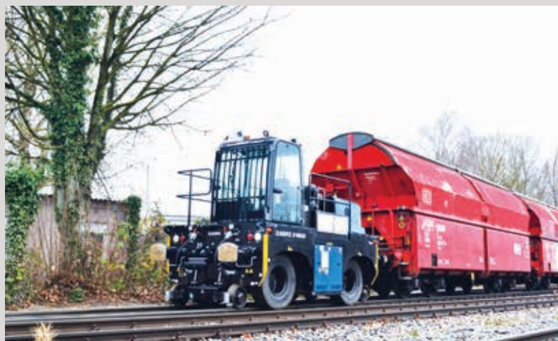
ZAGRO E-MAXI XXL ze zdalnym sterowaniem radiowym
