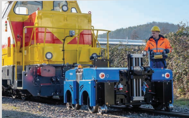
ZAGRO E-MAXI M z systemem regulacji wysokości sprzęgu
