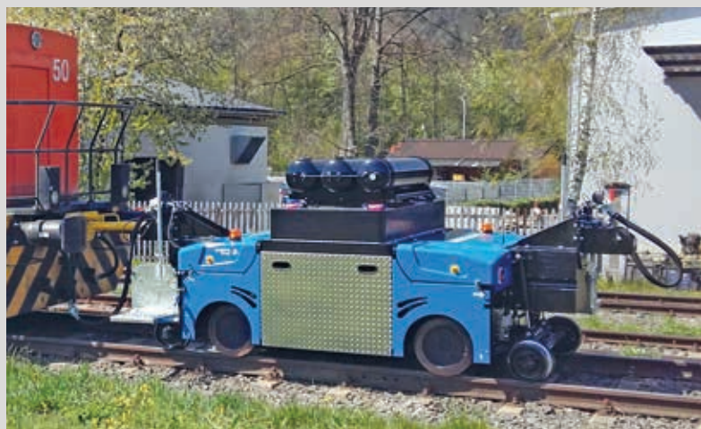
ZAGRO E-MAXI XL z systemem hamulcowym wagonów i podestem roboczym
